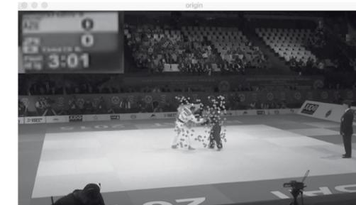
図7 カメラ 1 の試合映像にカメラ 2 の掲示板映像をオーバーラップ. 追跡の様子を示すパーティクルを赤で, 表示している.
